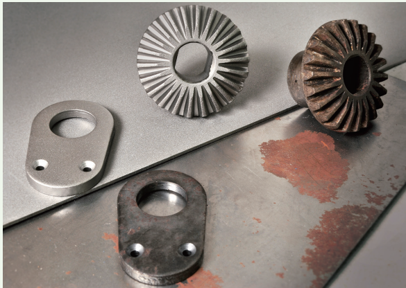
▲高細膩度的噴擊工法讓細小物件也能清潔溜溜。
